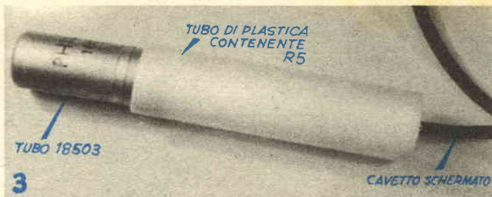
Il «probe» con il tubo 18503 collegato con cavetto schermato all'apparecchio
